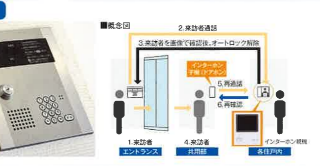
エントランスには、オートロックシステムを導入しました。各住戸に設置したTVモニター付のインターホンで、来訪者を確認してから解錠する、安心のシステムです。
